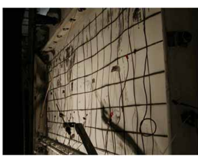
DS 3: Residual Web Plate Buckling
