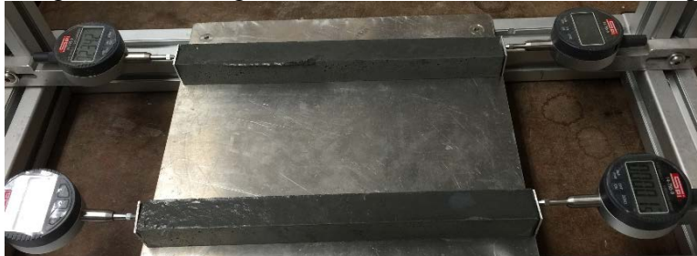
(d) Free Shrinkage Test of 1 inch x 1 inch x 11.25 inch prism
