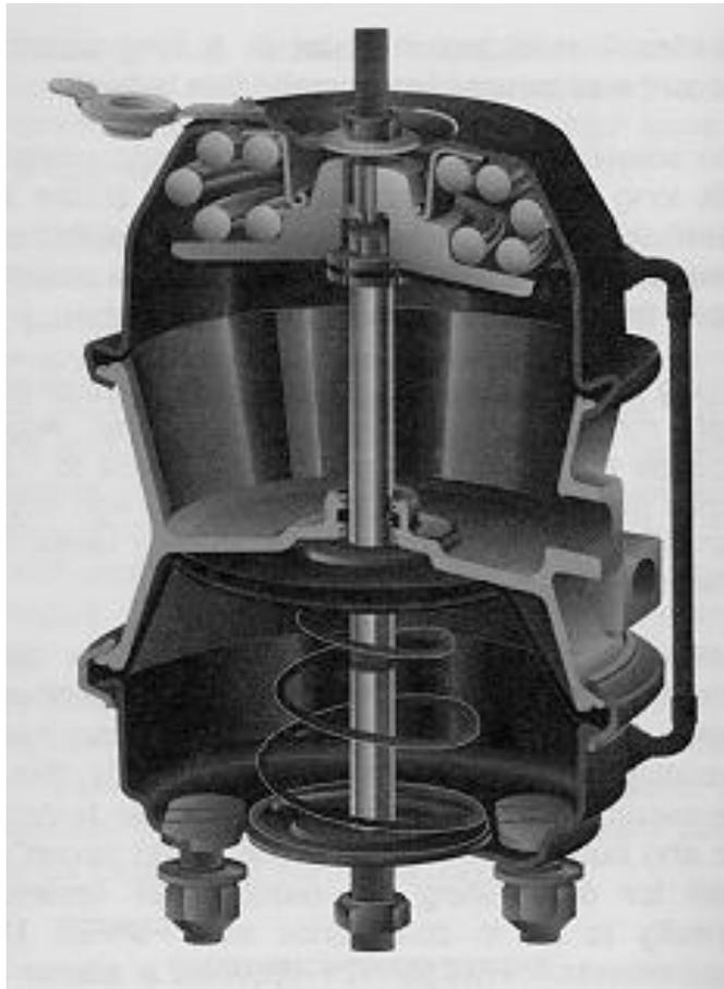
**FIGURE 2 MGM Air Brake Chamber [9].**
