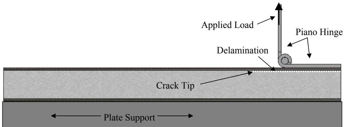
FIGURE 1. SINGLE CANTILEVER BEAM TEST CONFIGURATION
