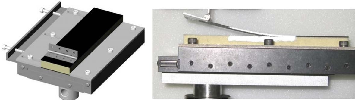
FIGURE 2. PROTOTYPE TEST FIXTURE FOR PLATE SUPPORTED SINGLE CANTILEVER BEAM (SCB) TEST
