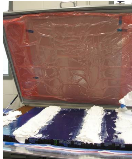
Core Potting using Corfill 658
